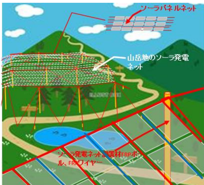
Fig:1 FRPポール・ワイヤーネットによる山岳地の太陽光発電
