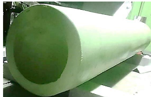
図1: CW 成形法によるFRP シリンダータンク
